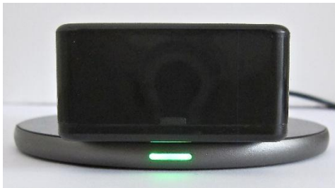
LED-Statusanzeige (grün): das RobiCare®-Geräte-Modul ist aufgeladen.
