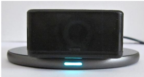
LED-Statusanzeige (blau): das RobiCare®-Geräte-Modul wird geladen.
